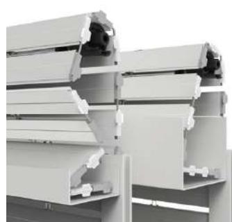
**Führungsgleiter** aus Polyamid sorgen für ein optimales Gleiten in der Führungsschiene. Sie sind so miteinander verbunden, dass das gleichzeitige Zusammenfallen von zwei oder drei Stäben in der Paketschale möglich wird. Die Führungsgleiter sind verstärkt und werden zusätzlich in die Stabenden eingestanzt (2-Stab-Version) oder mittels rostfreier Klammer fixiert (3-Stab-Version) um optimalen Windwiderstand des Behänge zu gewährleisten.
