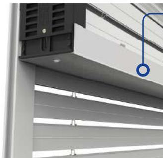
Untere **Abdeckung** für die Paketschale aus thermolackiertem Aluminium. Standardhöhe 40 mm (2-Stab-Version) und 100mm (3-Stab-Version). Bei Konstruktionsbreiten von über 2'000 mm wird eine verstärkte Abdeckung im Mass 100 mm geliefert.
