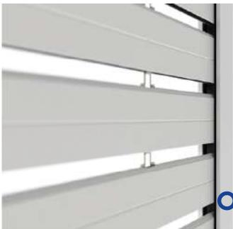
**Seitliche Führungsschienen** 19 x 37 mm, aus stranggepresstem, anodisiertem oder thermolackiertem Aluminium mit Geräuschdämpfungseinlagen.
