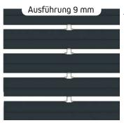
Die beweglichen Stäbe sind durch solide Chromnickelstahl-Haken miteinander verbunden. Die Verbindungshaken können die Stäbe bei geöffnetem Behang bis zu 3mm (Ausführung 3mm) bzw. 9mm (Ausführung 9mm) voneinander distanzieren, erlauben jedoch bei geschlossenem Behang eine vollständige Verdunkelung.
