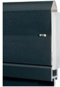
**Seitliche Führungsgleiter** aus Polyamid sorgen für ein optimales Gleiten in der Führungsschiene. Die Gleiter sind mittels rostfreier Klammer an der Führungsschiene befestigt und zusätzlich verstärkt, um einen besseren Windwiderstand des Panzers zu gewährleisten.
