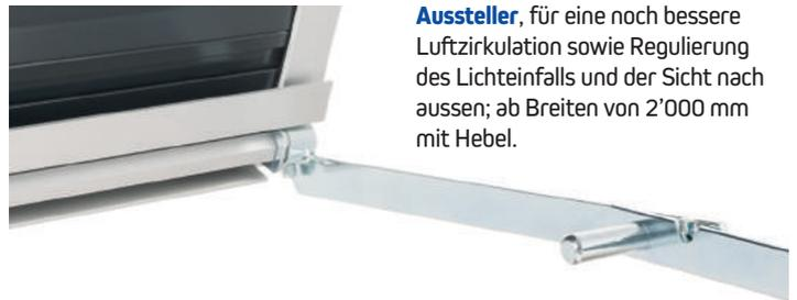
**Aussteller**, für eine noch bessere Luftzirkulation sowie Regulierung des Lichteinfalls und der Sicht nach aussen; ab Breiten von 2'000 mm mit Hebel.
