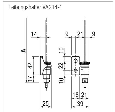
Leibungshalter VA214-1 wird für die eingerückte Seilführung bei Wandmontage als Wandhalter verwendet.
